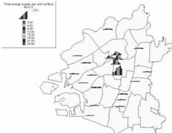
図2 土地利用用途別の電力・都市ガスによる単位面積当たりの供給エネルギー量の時空間分布
