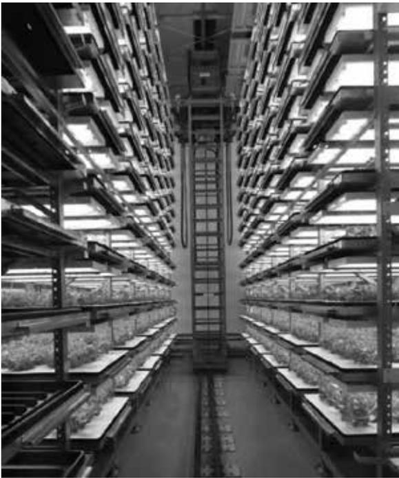
図4 自動化された多段タイプの栽培室
