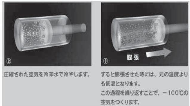
図3 空気圧縮後の冷却と膨張による低温発生
