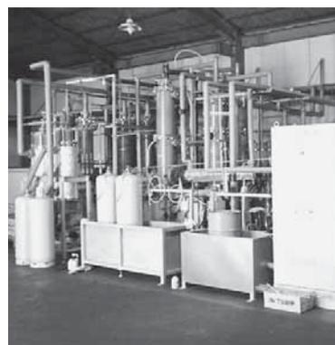
過熱蒸気式フロン分解装置
