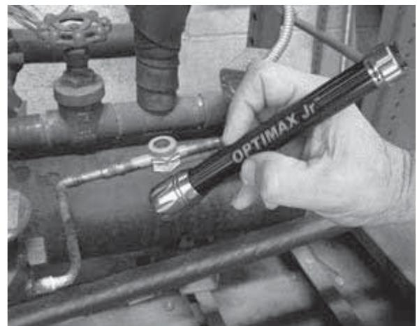
写真：紫外線ランプでの検査の様子
