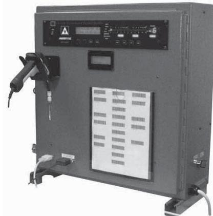
写真7 NIST トレース ガス質量分析器
